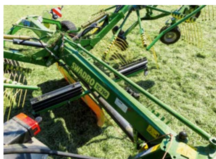
Die Achse verfügt über eine Zwanglenkung, die über eine Stange vom Anbaubock angesteuert wird.
