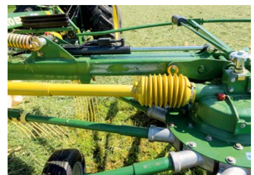
Mit der hydraulischen Breitenverstellung werden die Schwaden 0,8 m bis 1,60 m breit.
