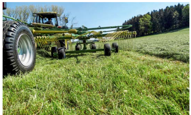
Das Tridem-Fahrwerk war bei der Testmaschine leider nur vorne mit lenkbaren Tasträdern ausgestattet.
