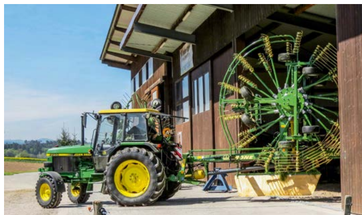
Für kleinere Remisen wird es mit der Höhe von knapp 400 cm eng. Klappbare Zinkenarme für 358 cm Höhe lohnen sich.
